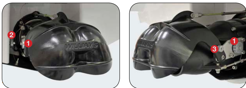
1 Ánodos de bomba 2 Ánodo de casco 3 Ánodo de cubo invertido
