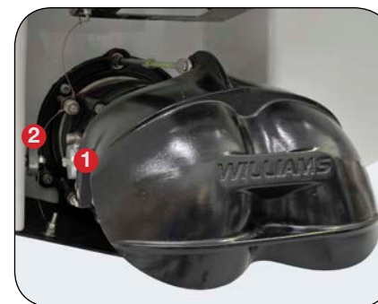
1 Anodi della pompa 2 Anodo dello scafo 3 Anodo dell'inversore di spinta
