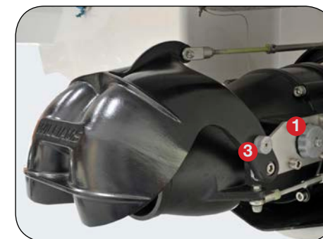
1 Anodi della pompa 2 Anodo dello scafo 3 Anodo dell'inversore di spinta
