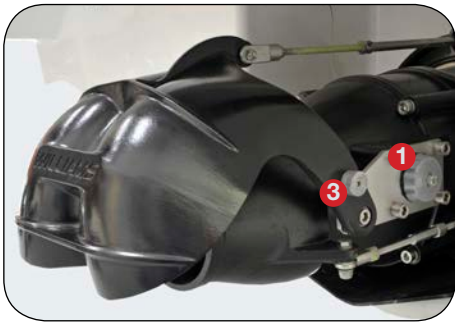
1 Anodes de turbine 2 Anode de coque 3 Anode d'auget d'inversion
