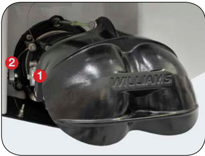
1 Anodes de turbine 2 Anode de coque 3 Anode d'auget d'inversion
