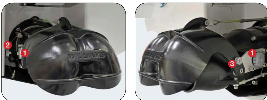
1 Anoda pumpe 2 Anoda trupa 3 Anoda posude za hod unazad
